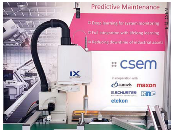
Predictive Maintenance Testmaschine mit Feeder, Roboter, Kameras und Förderbänder.
